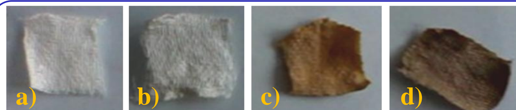
Cotton gauze specimens: a) CG; b) CaAlg/CG; c) CaAlg/TiO 2 -Ag/CG; d) CaAlg/TiO 2 -Ag/RGO/CG
